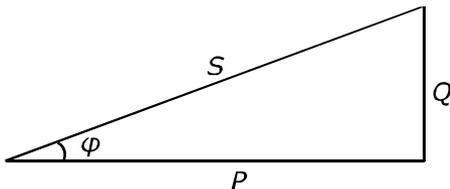
功率因数没有单位，取值范围为-1 至 1 区间，大小与电路的负载性质有关，负载通常分为三种：阻性、感性、容性。纯阻性的负载功率因数为 1，如白炽灯、电热丝等电阻负载的功率因数为 1。感性负载通常指电磁设备，如交流电机、变压器、电感器等。容性负载是指电容负
