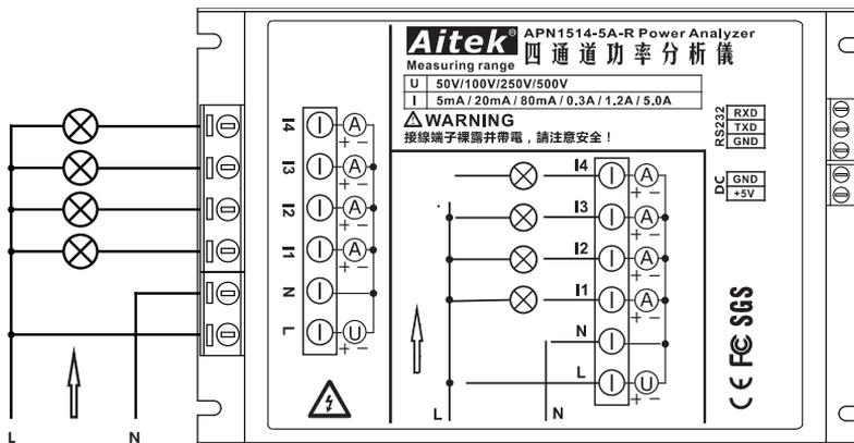
上图描述了一个可同时测量四路负载的单相测量系统接线图，在这个系统中，电压采样采用U（N端子和L端子），电流采样采用I1、I2、I3、I4端子，下图为这种接线图的等效电路：
