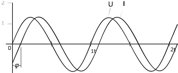
初相角的单位可以用弧度(rad)或(deg)来表示, 两者的对应关系为  $\pi(\text{rad}) = 180^\circ(\text{deg})$ 。通常相位应在  $|\varphi| < \pi$  的范围内取主值, 即  $\varphi$  的区间限定在  $-\pi \leq \varphi \leq \pi$  的范围。
