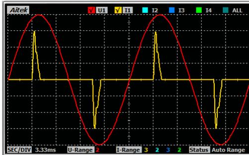
波形查看窗口能查看四个功率测量通道的电压和电流采样波形，通过点击窗口右上角的选择框，可以挑选用户指定的信号显示，如用户只需选择电压信号显示，只需把 U1 选上就行了。
