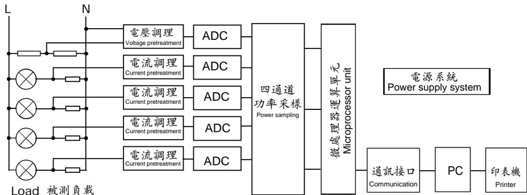
整机由一路电压、四路电流调理电路、五路 ADC 模数转换器电路、微处理器运算电路、RS485/RS232 通讯电路、电源电路、PC 端软件组成。
