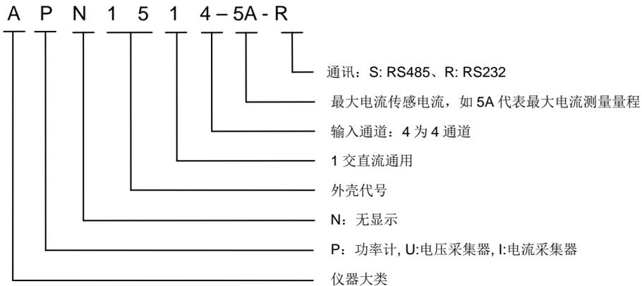
目前 APN1514 系列多通道功率分析模块为安装式功率分析模块。按传感器端子最大输入电流范围分为多种子型号，以适应市面不同功率大小的负载测量。型号的最后一位标识是带通讯的识别码，S:RS485、R:RS232，如：APN1514-5A-R 为 RS232 接口的机型，APN1514-5A-S 为 RS485 接口的机型，均适宜用于 ATE 自动化、高精度测量等应用。
