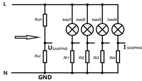
上图描述了 APN1514 系列功率测量模块的测量等效原理图，测量电源从 N 和 L 端输入，通过分压电阻  $R_{uh}$  和  $R_{ul}$  分压，从  $R_{ul}$  两端得到电压采样电压。L 端电流流经各路被测量负载 **Load**，再流经各路电流传感器  $R_i$ ，回到 N 端子，电流采样信号从各路电流传感器  $R_i$  两端取出。这样就形成了一路电压，四路电流的单相四通道功率采样系统。在系统中，因为电流传感器  $R_i$  存在一定的电阻值，在测量小电流信号时，这电阻值的功耗小到可以忽略不计，但当电流增大，便会存在一定的功耗，会影响功率的测量结果，为此，仪器增设了一个叫“电流传感器补偿”的设置选项，就是把这每个测量回路的功率值减去每个电流传感器的功耗，以抵消这个传感器功耗的存在，提高功率测量精度。
