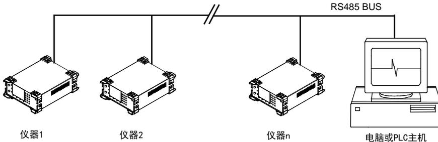
RS-485 一般只需二根联机，所以 RS485 接口均采用屏蔽双绞线传输。本仪器的 RS485 采用半双工通信。采用三个接线端子，两条信号线：A+ 和 B-，一条屏蔽线地线 COM。两条信号线必须与主机的 RS485 接口正确连接。若有多台仪器组成网络，采用并联的方式将信号线和主机连
