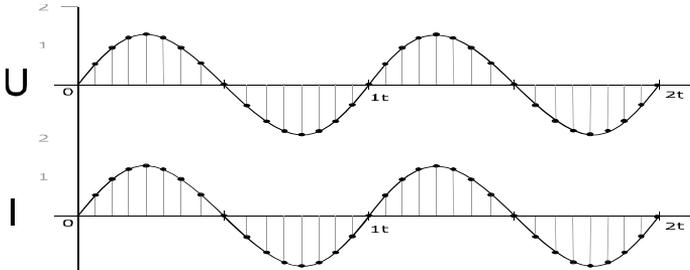
我们将电压和电流信号数字离散化，得到电压序列  $U[n]$  和电流序列  $I[n]$ ，然后求得瞬时功率序列  $P[n]$ ，再求瞬时功率序列  $P[n]$  的平均值，这平均值便是我们需要的真功率值，也称为真有功功率。
