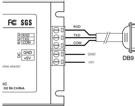
本仪器的 RS232 通讯速度可选择，详细查看菜单操作章节，而且主机跟仪器之间的通讯速度必须一致才能正常通讯。通讯协定与 MODBUS-RTU 一致，详细请参阅：仪器的高级编程。
