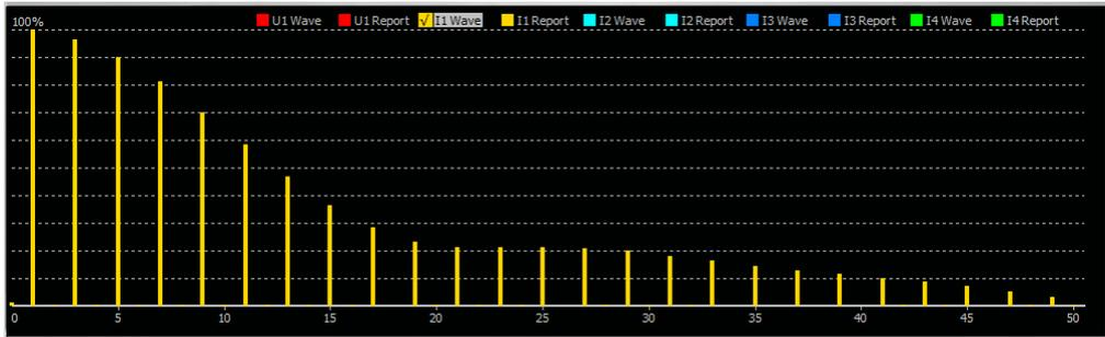
APN1514 能测量电压和电流的 0-50 次谐波数据，点击谐波窗口的右上角的英文字符，能够切换显示各通道的电压谐波含量图、电压谐波报告、电流谐波含量图、电流谐波报告。
