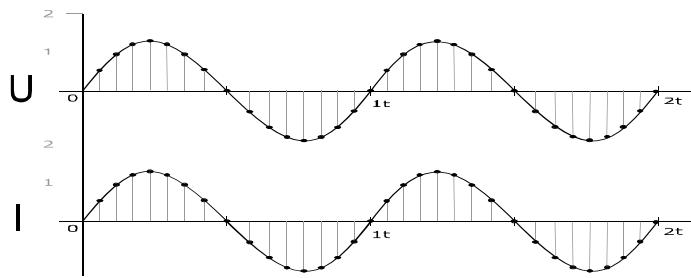
我们将电压和电流信号数字离散化，得到电压序列  $U[n]$  和电流序列  $I[n]$ ，然后求得瞬时功率序列  $P[n]$ ，再求瞬时功率序列  $P[n]$  的平均值，这平均值便是我们需要的真功率值，也称为真有功功率。
