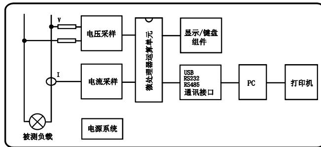
整机由电压/电流采样电路、微处理器运算电路、RS485/RS232 通讯电路、电源电路、PC 端软件组成。
