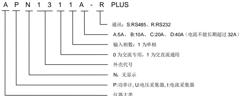
目前 APN1311 系列功率分析仪为单相安装式功率分析仪。按最大输入电流量程分为 5 种，A:5A、B: 10A、C: 20A、D: 40A。型号的最后一位标识是带通讯的识别码，S:RS485、R:RS232，如：APN1311A-R 为 RS232 接口的机型，APN1311A-S 为 RS485 接口的机型，均适宜用于自动化控制、测量、电力监控等应用。
