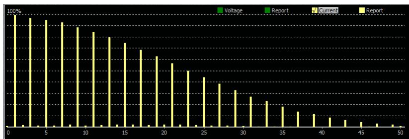
APN1211 能测量电压和电流的 0-50 次谐波数据，点击谐波窗口的右上角的英文字符，能够切换显示电压谐波含量图、电压谐波报告、电流谐波含量图、电流谐波报告。
