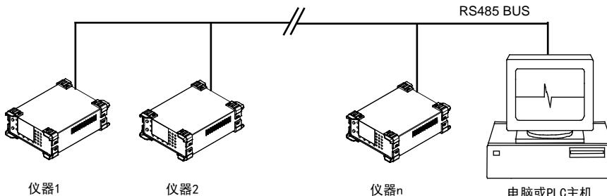
RS-485一般只需二根联机，所以RS485接口均采用屏蔽双绞线传输。本仪器的RS485采用半双工通信。采用三个接线端子，两条信号线：A+和B-，一条屏蔽线COM。两条信号线必须与主机
