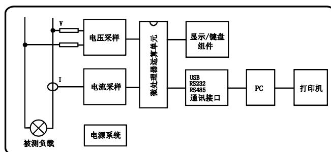
整机由电压/电流采样电路、微处理器运算电路、USB/ RS485/RS232 通讯电路、电源电路、PC 端软件组成。
