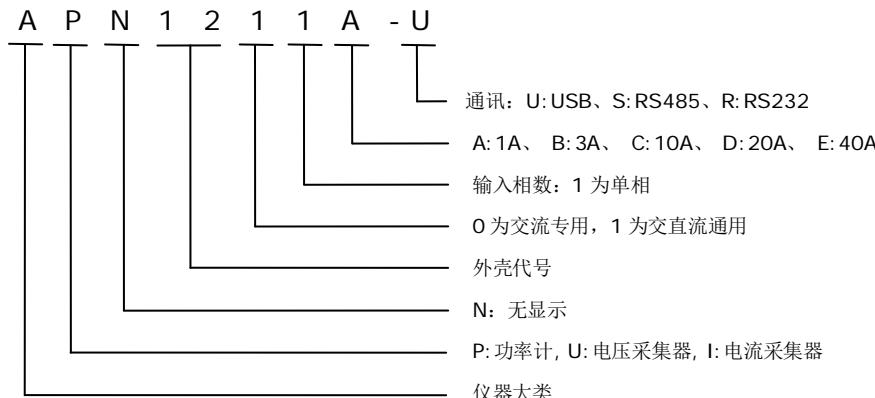
目前APN1211系列功率分析仪为单相便携式功率分析仪。按最大输入电流量程分为5种，A:1A、B: 3A、C: 10A、D: 20A、E: 40A。型号的最后一位标识是带通讯的识别码，U:USB、S:RS485、R:RS232，如：APN1211A-U为USB接口的机型，具有快速的通讯速度，较适宜于实时测量。APN1211A-S为RS485接口的机型，较适宜用于自动化控制、电力监控等应用。
