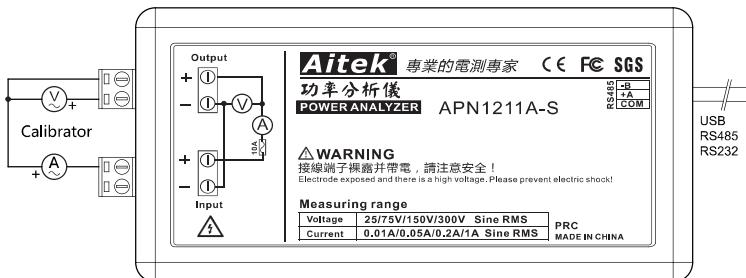
APN1211A、APN1211B、APN1211C、校准接线图：
