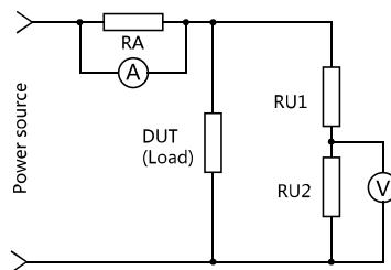
在上图中，RA 为电流采样传感器，DUT(Device Under Test)为被测量负载，RU1 和 RU2 为电压采样电阻。在仪器的正常测量中，由于电压采样分压电阻 RU1 和 RU2 的存在，会产生一定的电流，会耗损一定的功率，这个电流会被 RA 检测到，为了还原 DUT 的实际功率，仪器在测得功率值后会减去 RU1 和 RU2 的功率值。
